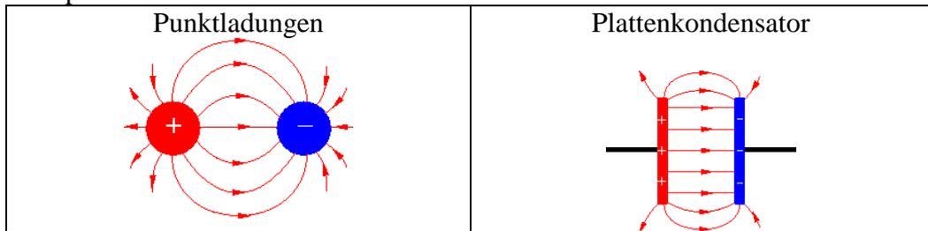
Frei bewegliche Ladungen werden im elektrischen Feld entlang der Feldlinien beschleunigt (Anwendung: Oszilloskop)
