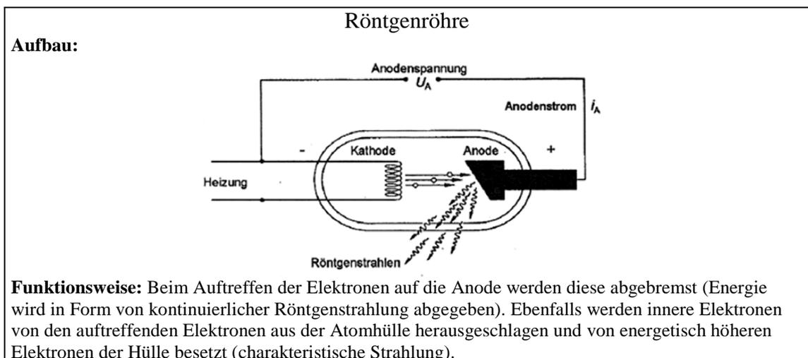
**Funktionsweise:** Beim Auftreffen der Elektronen auf die Anode werden diese abgebremst (Energie wird in Form von kontinuierlicher Röntgenstrahlung abgegeben). Ebenfalls werden innere Elektronen von den auftreffenden Elektronen aus der Atomhülle herausgeschlagen und von energetisch höheren Elektronen der Hülle besetzt (charakteristische Strahlung).
